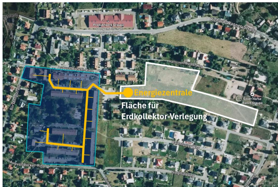
Abbildung 36: Beispielhaftes Nahwärmekonzept für den August-Röckel-Ring mit einem (nach Installation wieder nutzbaren) Erdkollektorfeld für eine Wärmepumpe. Kartengrundlage: Google
