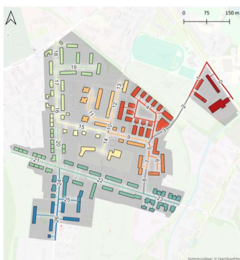
Abbildung 33: Simulation des Ausbaus von Fernwärme über 26 Gebäudecluster. Cluster (links) und sich ergebende Wärmebedarfe und mittlere Wärmeliniendichten (rechts)
